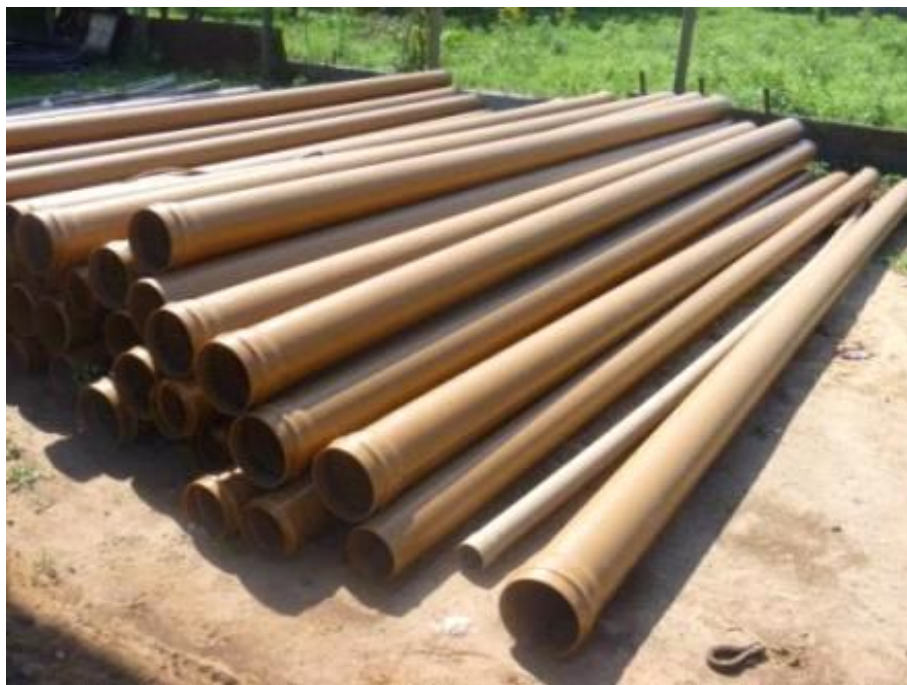
Foto: Tubos de PVC ocre, indicado para o uso em pisciculturas por ter maior resistência que o PVC branco comum, de esgoto.
